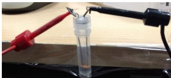
Slika 6: Praktični prikaz elektroformacije v navpični viali (Fotografija last avtorjev in mentorjev).
