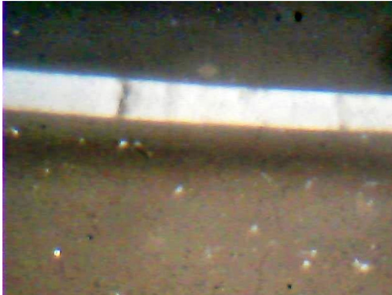
Slika 32: Mikroskopska slika magnezijevega silikata, ustvarjenega v natrijevem silikatu [osebni arhiv]
