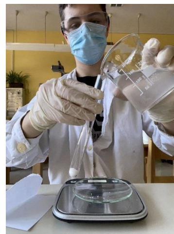
Slika 16: Dodajanje raztopine čez prah magnezijevega sulfata [osebni arhiv]
