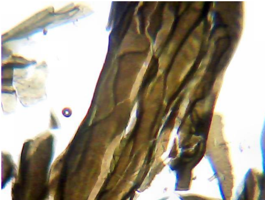
Slika 25: Mikroskopska slika železovega silikata ustvarjenega v natrijevem silikatu [osebni arhiv]
