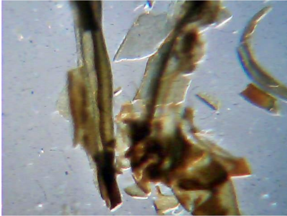
Slika 27: Mikroskopska slika železovega silikata, ustvarjenega v raztopini natrijevega silikata in destilirane vode [osebni arhiv]
