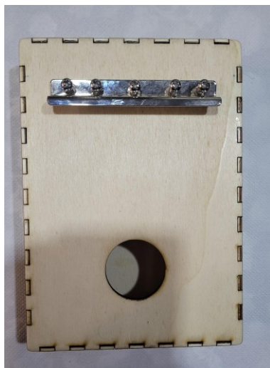
SLIKA 3. 30: NAMESTITEV KOVINSKEGA OGRODJA IN KOVINSKE OPORNE PALICE
