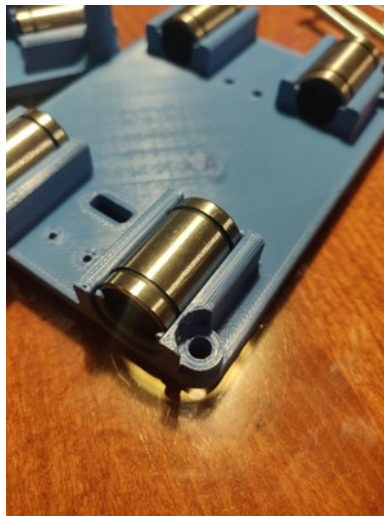
Slika 3. 7: Nameščanje ležajev v pomično glavo .
