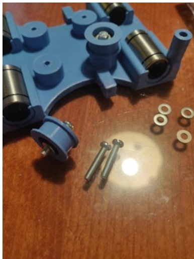
Slika 3. 9: Nameščanje ležajev v pomično glavo.
