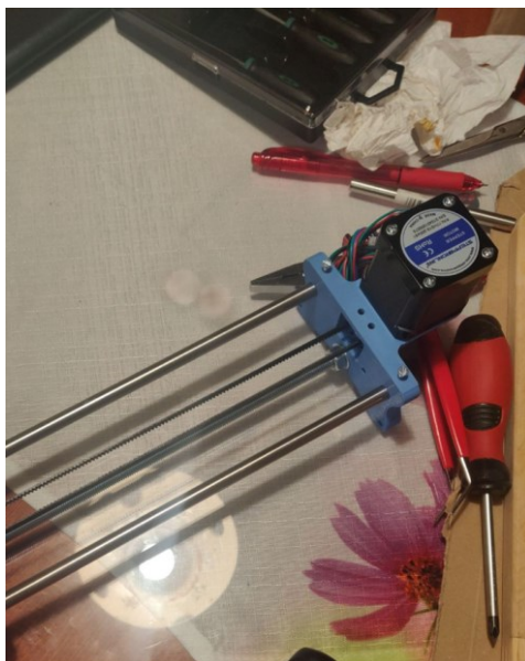
Slika 3. 10: Pritrditev motorja na os X.
