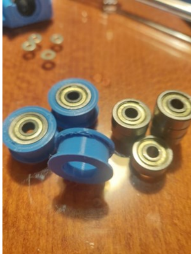
Slika 10 Nameščanje ležajev v pomično glavo.
