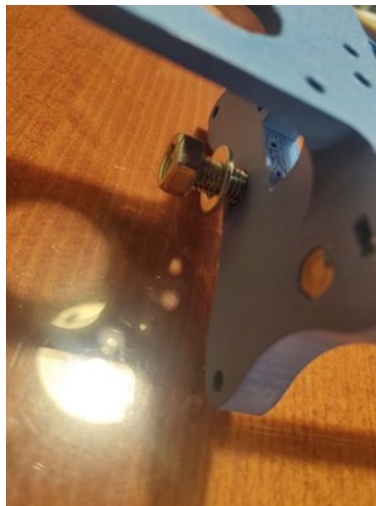
Slika 3. 5: Vstavljanje kovinskih palic in palice z navojem v nosilec osi X.
