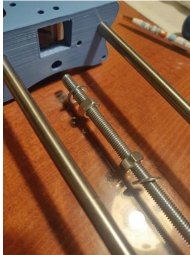
Slika 3. 4: Vstavljanje kovinskih palic in palice z navojem v nosilec osi X.
