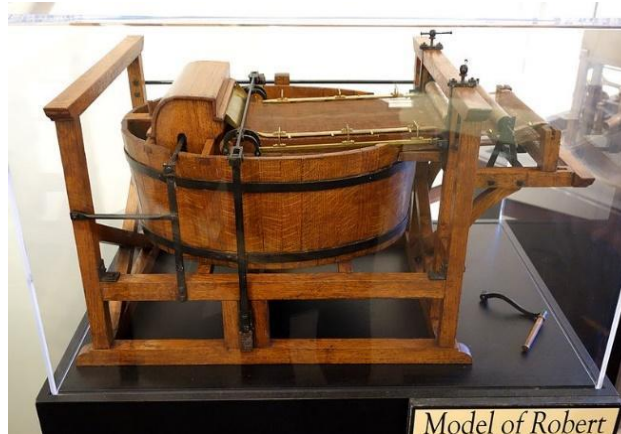
Slika 16: Model prvega papirnega stroja
