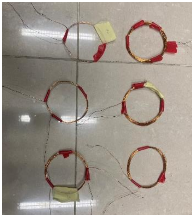
Slika 7: Tuljave z različnim številom ovojev
