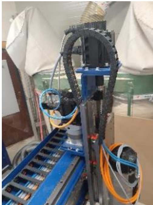
Slika 50: Montaža energetske verige na z osi
