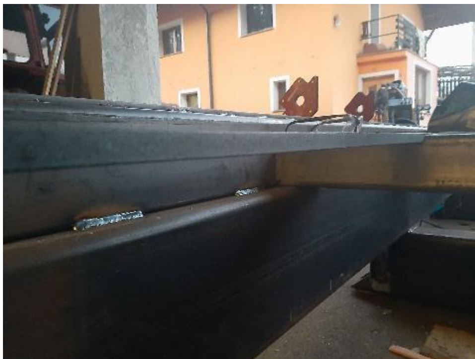
Slika 23: Miza, zavarjena na podnožje
