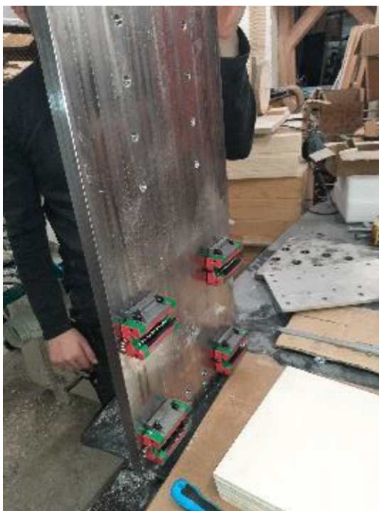
Slika 41: Namestitev drsnih vozičkov (Vir: Osebni arhiv)
