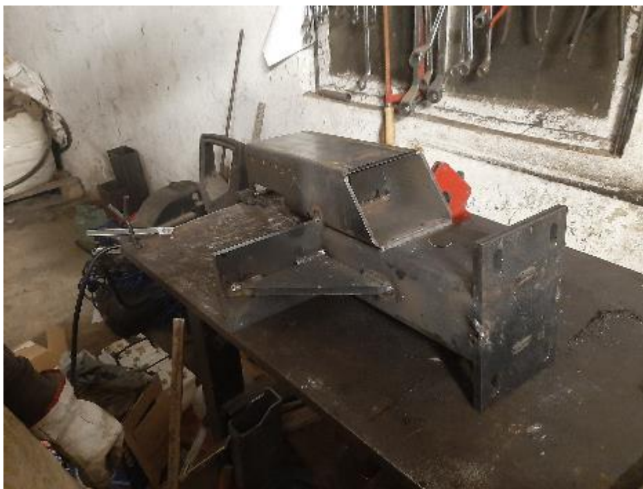
Slika 28: Steber mostu zavarjen
