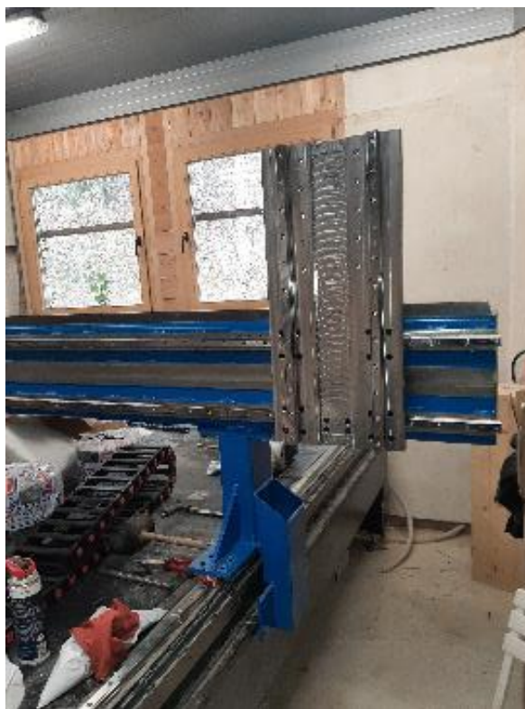
Slika 42: Montaža z osi na most (Vir: Osebni arhiv)
