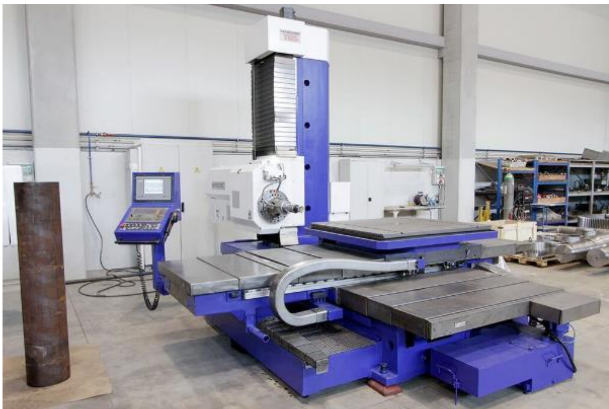
Slika 34: Rezkalni stroj Bohrwerk
