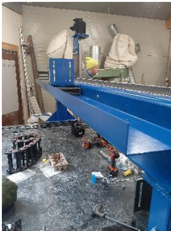
Slika 48: Montaža kanala za energetske verige na x osi
