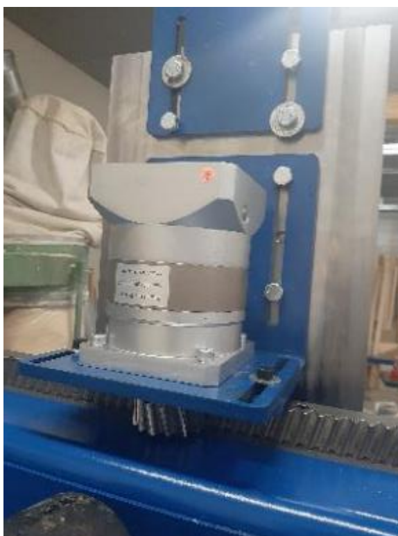
Slika 46: Montaža reduktorja na x osi
