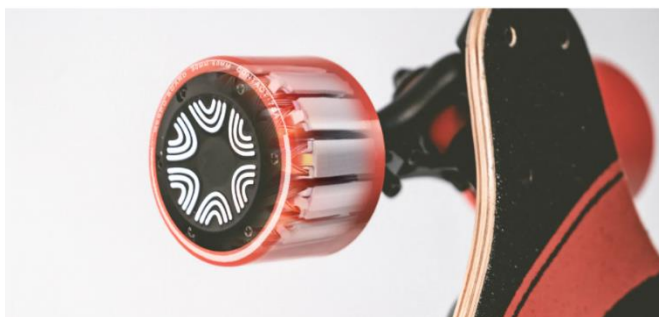
Slika 2 Izvedba motorja v kolesu rolke Vir: [2]
