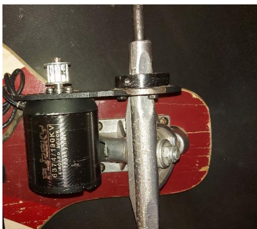
Slika 25 Motor pritrjen na nosilec Vir: (osebni vir)
