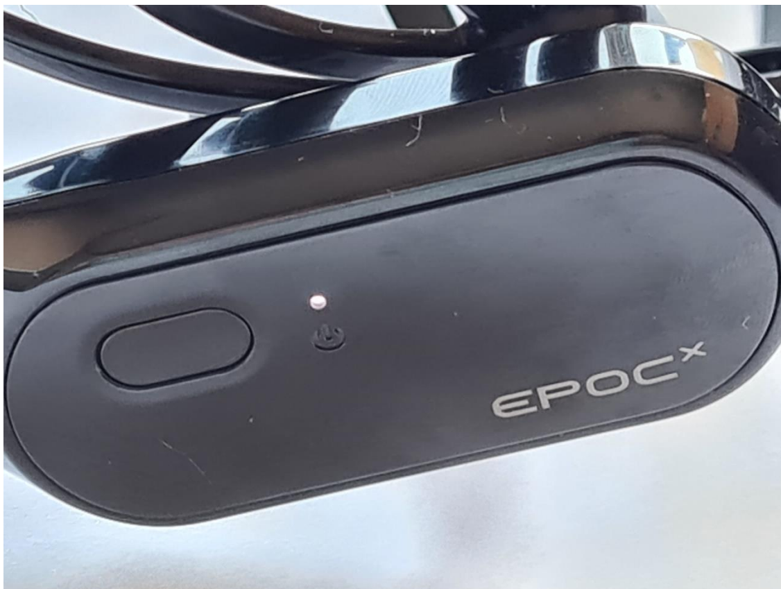
Slika 47: Gumb za vklop/izklop vmesnika ter LED lučka
