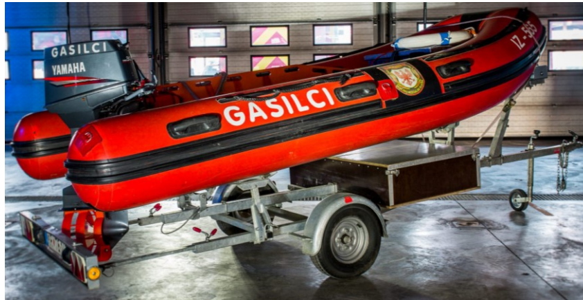
Slika 36: Priklopnik za reševalni čoln PČ
