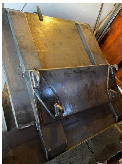
Slika 13: Priklop in ojačitve (osebni arhiv)
