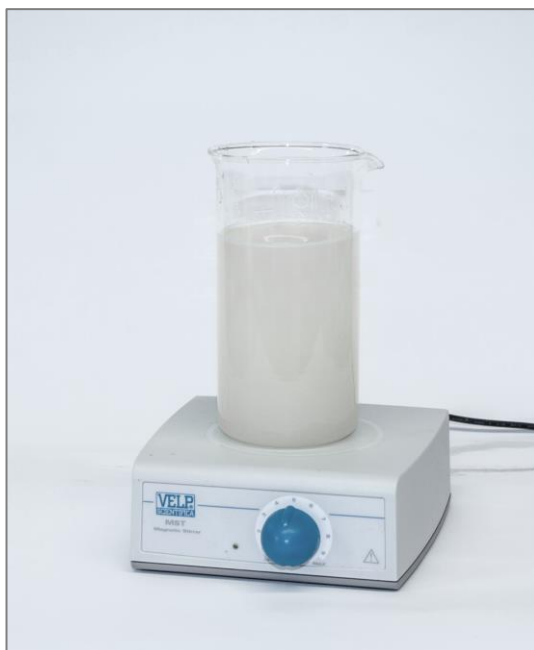
Slika 5: Vzorec čebule pred titracijo
