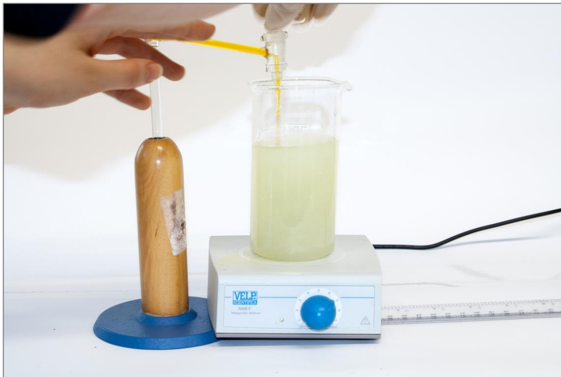
Slika 4: Titracija vzorca čebule
