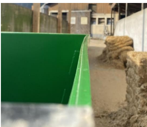
Slika 59: Deformacija pri varjenju (Osebni vir)
