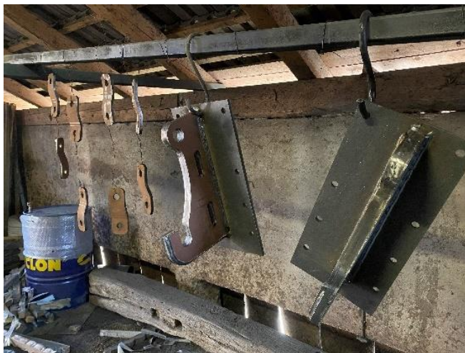
Slika 53: Kosi, pripravljeni na površinsko zaščito
