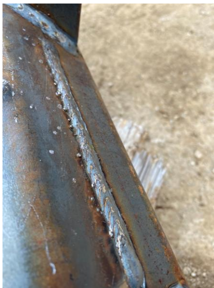
Slika 52: Odstranjevanje obrizgov (Osebni vir)
