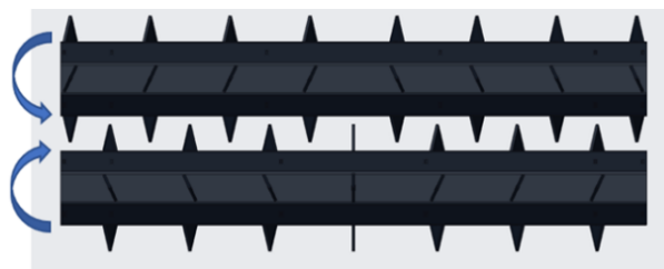
Slika 27: Smer vrtenja drobilnih valjev (Osebni vir)
