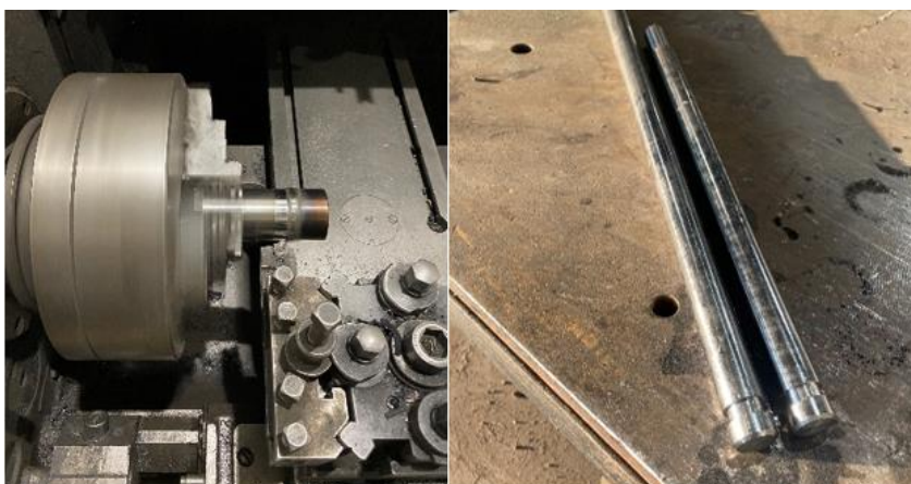
Slika 46: Izdelava osi (Osebni vir)
