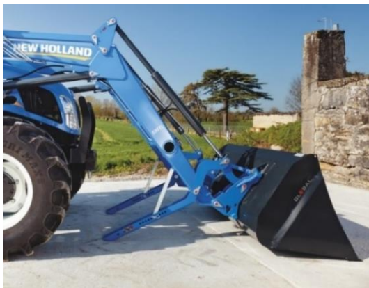
Slika 16: Primerna podlaga za priklapljanje/odklapljanje naprave
