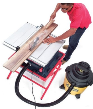
SLIKA 2.8: PRIKAZ MEHKEGA NASTAVKA DIREKTNO NA ORODJE S KATERIM DELAMO 2
