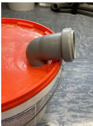
SLIKA 3. 3.10: VSTAVLJANJE PLASTIČNEGA KOLENA V IZREZANO LUKNJO 1
