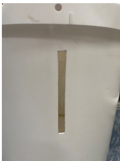
SLIKA 3. 3.13: IZREZANA LUKNJA NA STRANI PLASTIČNE POSODE ZA OCENO KOLIČINE POSESANIH DELCEV
