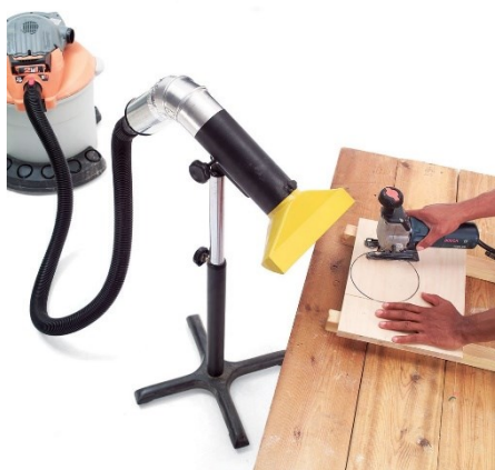
SLIKA 2.9 PRIKAZ SESANJA, ČE NASTAVKA NI MOGOČE NAMESTITI DIREKTNO NA ORODJE
