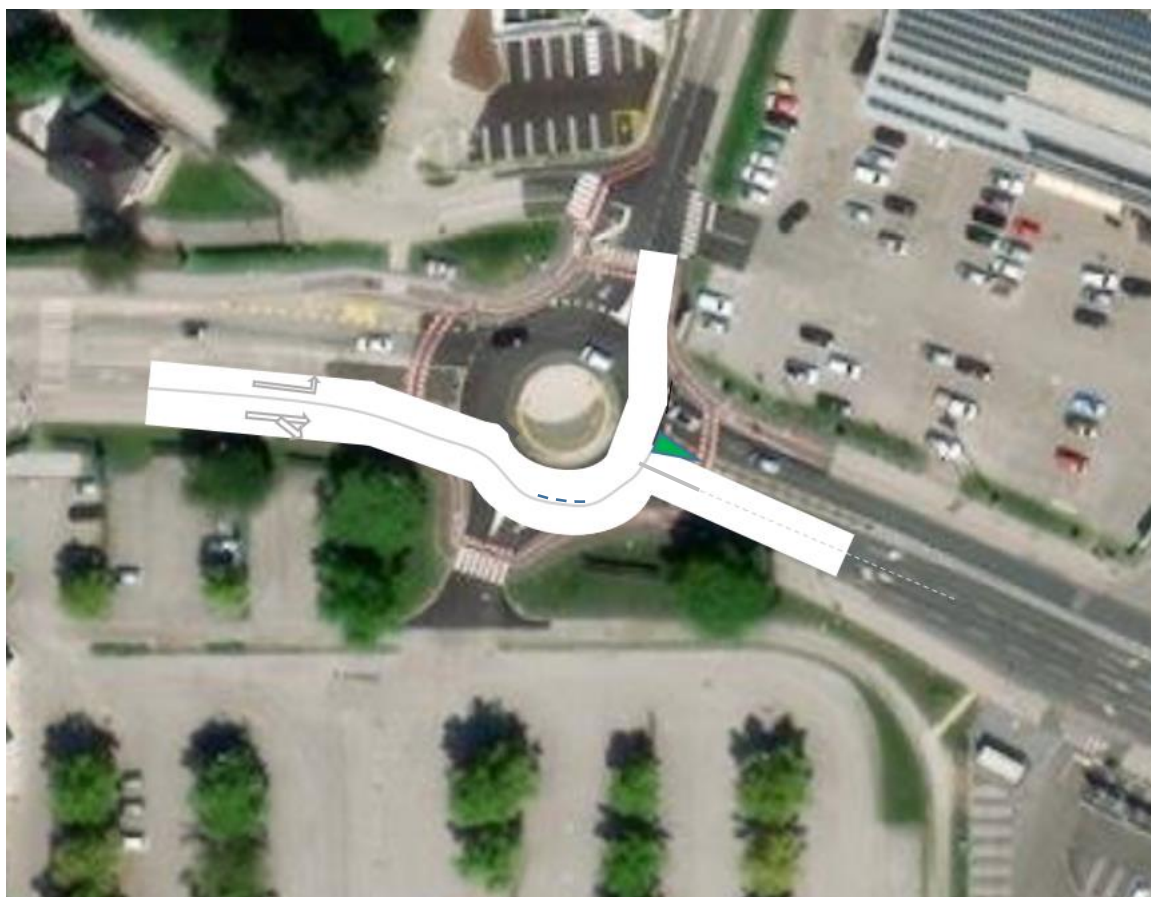
Slika št. 20: Simulacija prometnih tokov v krožnem križišču
