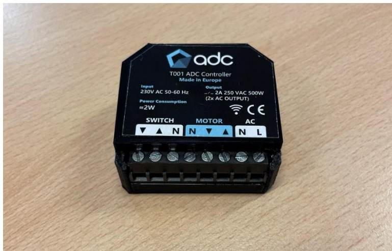
Slika 24: ADC rele za upravljanje rolet z mobilnim telefonom
