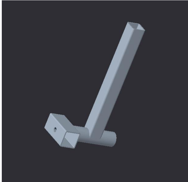
Slika 7: 3D-model nagibnega dela rahljalnika (osebni arhiv)
