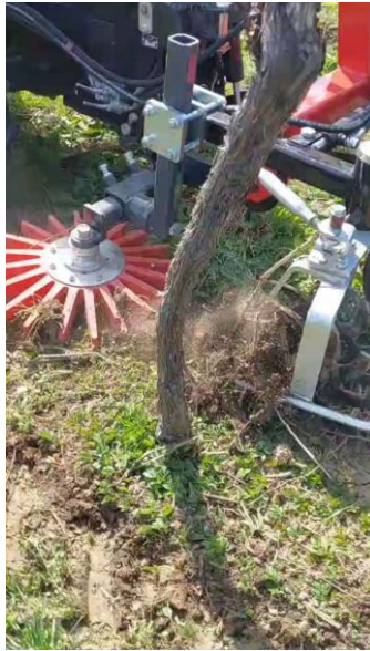
Slika 18: Vinogradniški okopalnik med obratovanjem (osebni arhiv)
