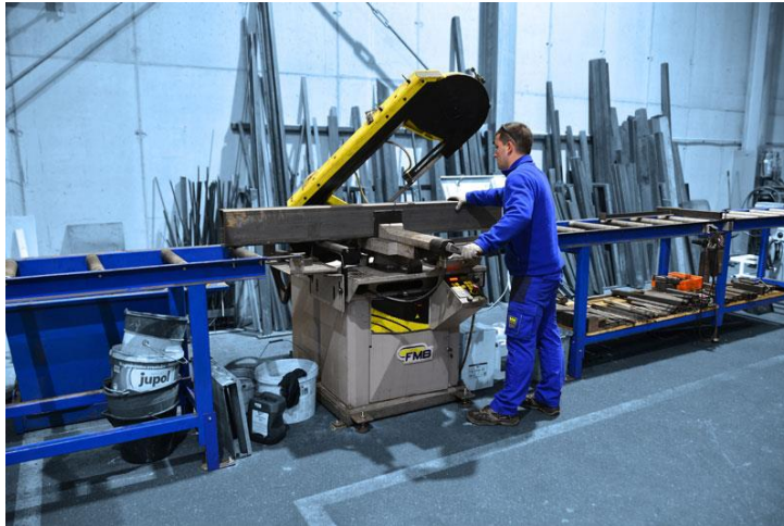
Slika 11: Razrez cevnih profilov [4]
