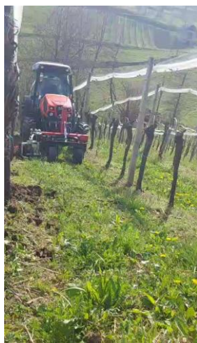
Slika 16: Traktor s vinogradniškim okopalnikom med obratovanjem
