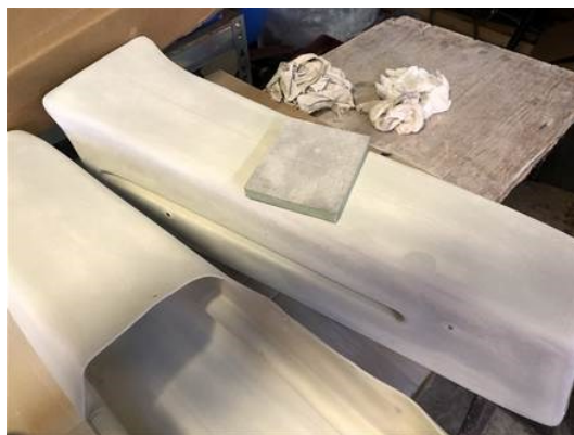
Slika 31: Brušenje plastik po barvanju 31
