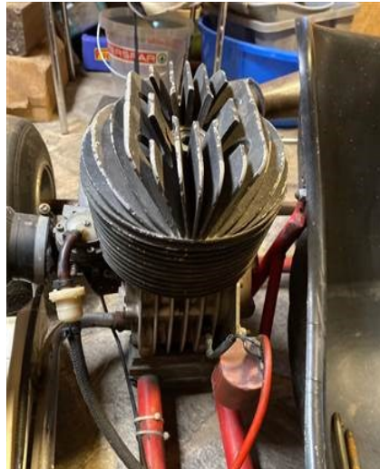
Slika 14: Primer zračno hlajenega agregata DAP T70 14
