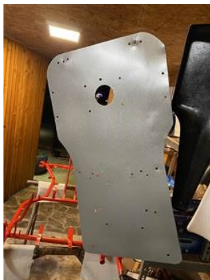
Slika 27: Aluminijasta plošča po peskanju in prašnem lakiranju 27
