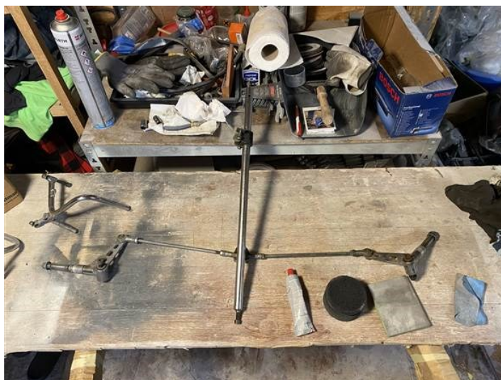
Slika 33: Krmilni sklop pred obdelavo 33
