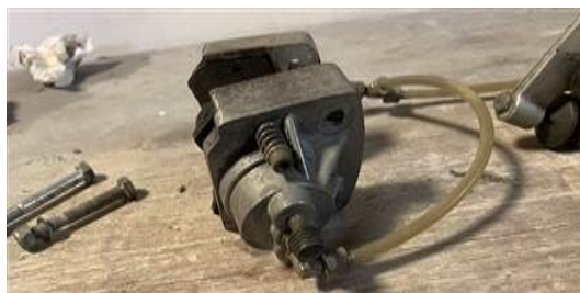
Slika 35: Čeljust zavore pred obdelavo 35
