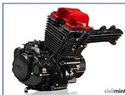
Slika 16: Oljno hlajeni agregat 16
