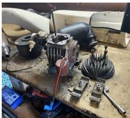
Slika 17: Začetek razstavljanja agregata 17
