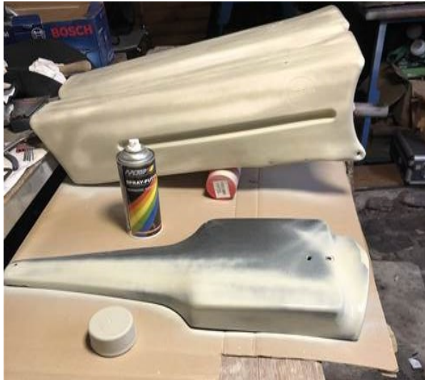
Slika 30: Začetek kitanja plastik po brušenju 30
