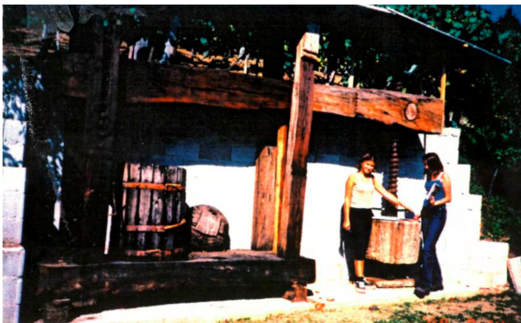
Slika 7: Tradicionalno leseno stiskalnico sestavljajo naslednji sestavni deli: kamen, vreteno, žmek, prešpank, klada, kad, koš, baba, ded in rigel.
