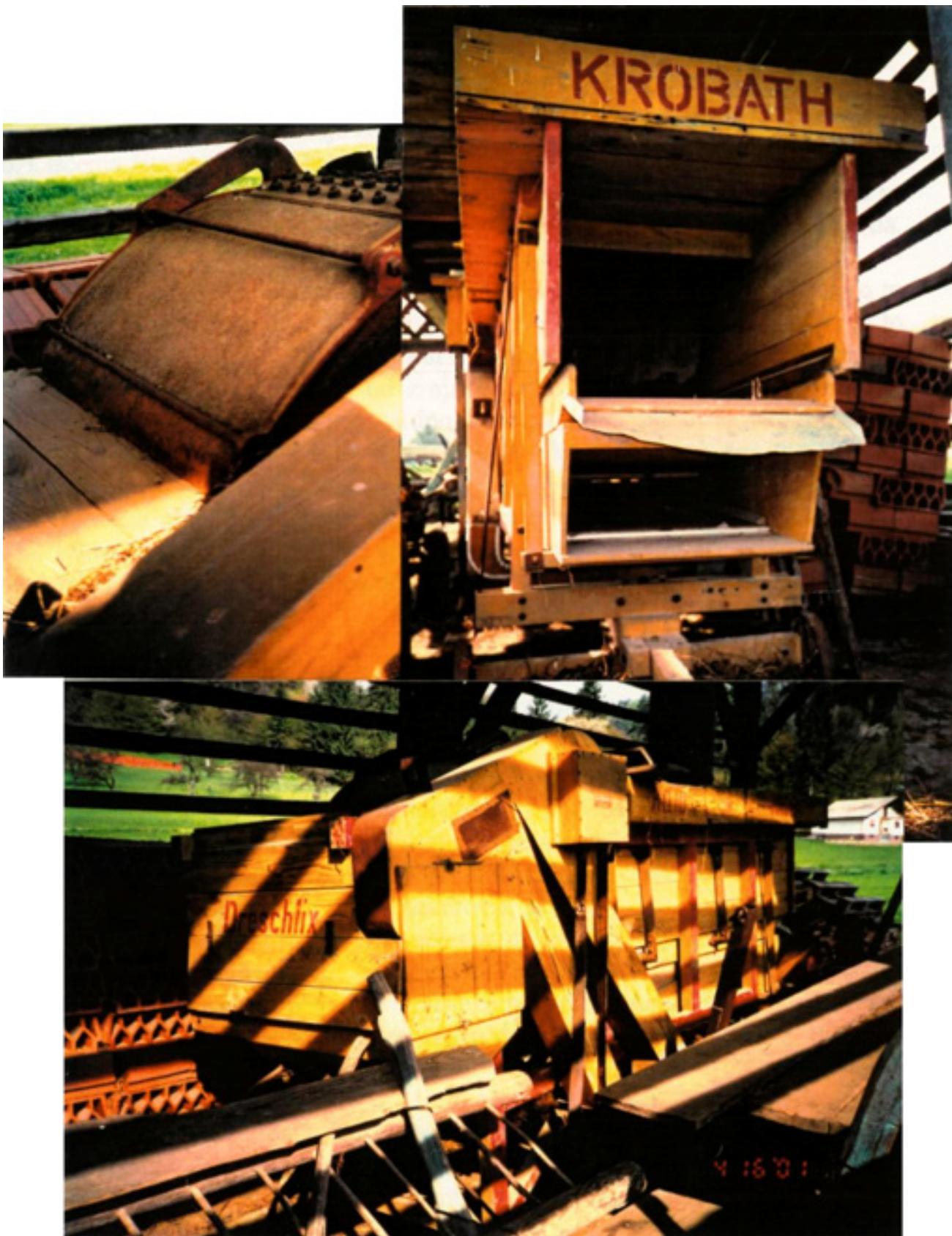
Slike 21, 22 in 23: Mlatilnica za mlatev žitaric, kakršne so uporabljali pred uvedbo kombajnov.
