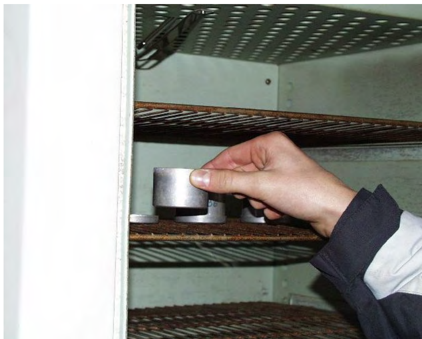
Slika 9: VSTAVLJANJE VZORCEV ZEMLJE V SUŠILNO NAPRAVO
