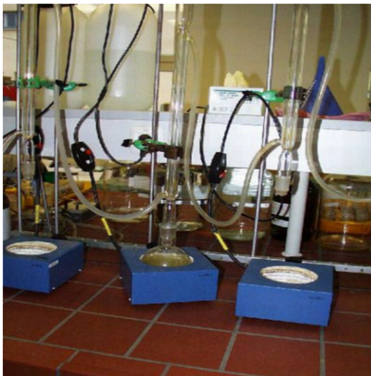
Slika 17: SEGREVANJE S POMOČJO POVRATNEGA HLADILNIKA
