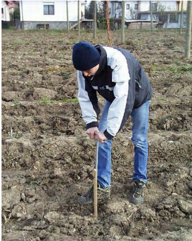
Slika 4: JEMANJE VZORCEV ZEMLJE S SONDO
