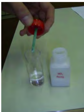
SLIKA 15: Merjenje vsebnosti nitritnih ionov.
