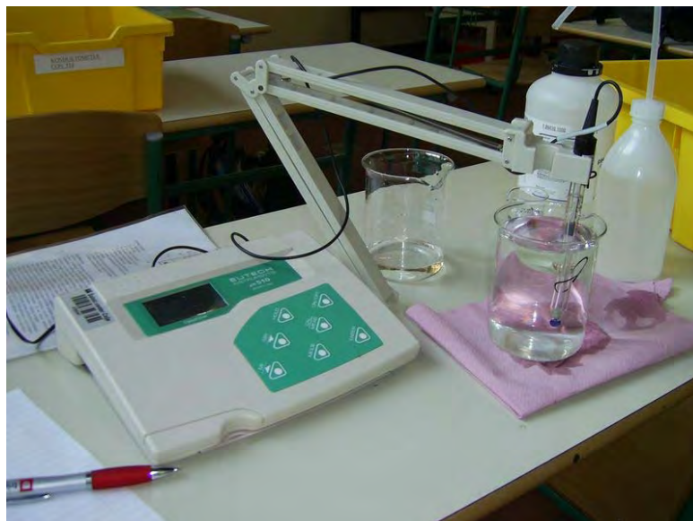
SLIKA 17: Merjenje pH vzorca.
