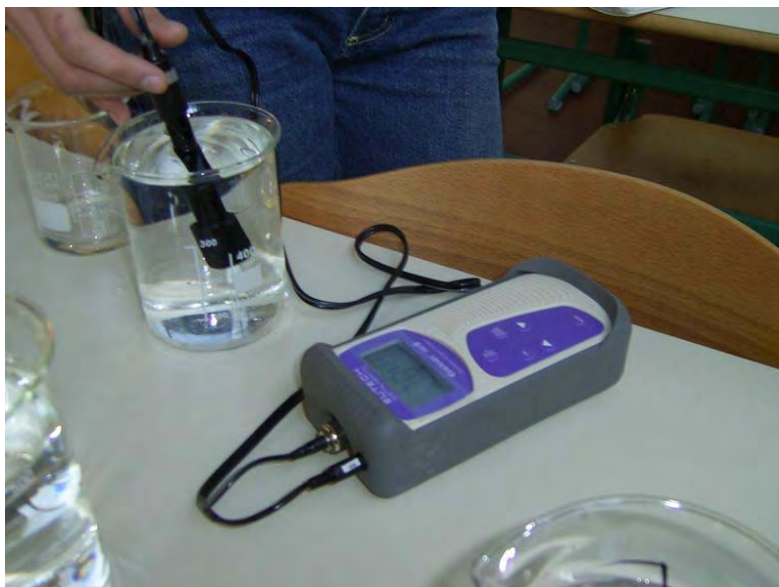
SLIKA 19: Merjenje kisika v vzorca.
