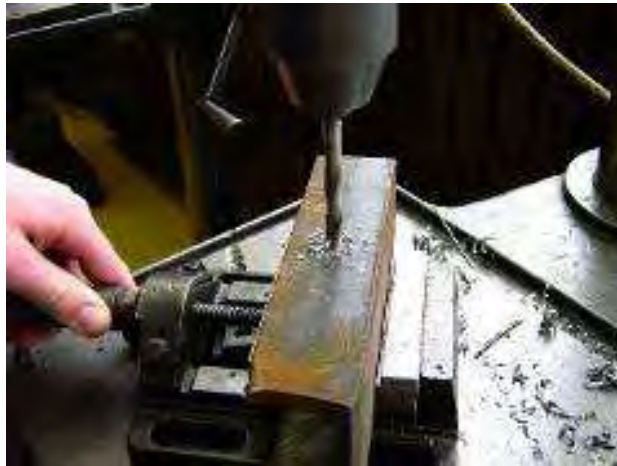
Slika 19: Vrtanje glavnega nosilca
