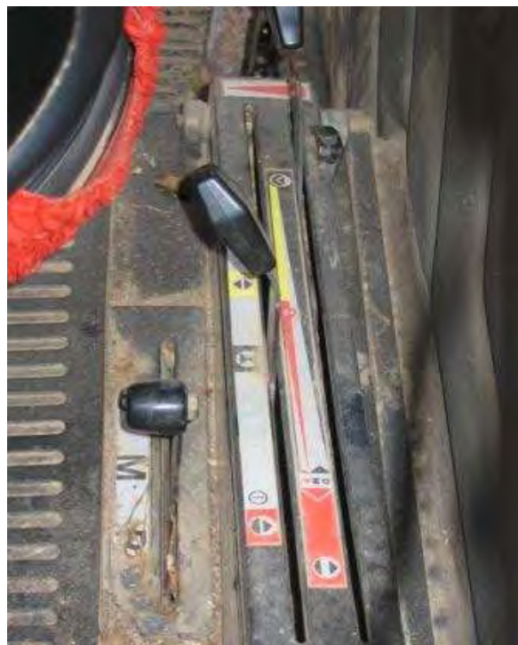
Slika 11.1; Upravljalna plošča v traktorski kabini za hidravlično črpalko traktorja
