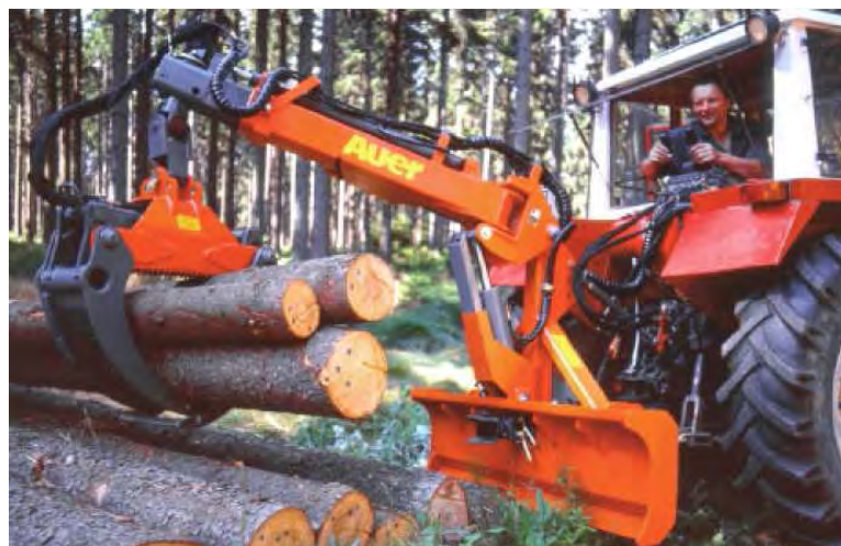
Slika 6.2.1 ; Nakladalna naprava za spravilo lesa iz gozda in natovarjanje lesa Auer
