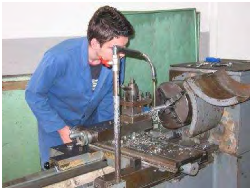
Slika 10.3; Obdelava surovca na končni izdelek (struženje)
