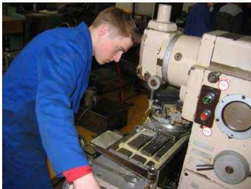
Slika 10.5; Obdelava polizdelka na končni izdelek (rezkanje – frezanje)
