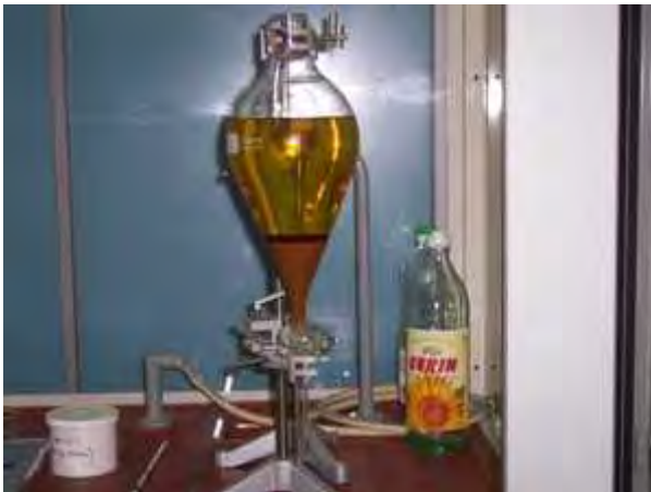
Slika 15: Ločevanje biodizla iz odpadlega rastlinskega olja
