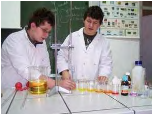
Slika 22: Titracija biodizla z 10-odstotno raztopino citronske kisline
