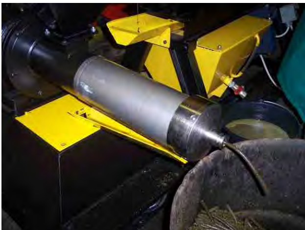
Slika 2: Stiskanje oljne ogrščice
