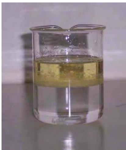
Slika 10: Biodizel je lažji od vode
