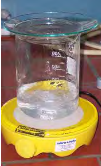
Slika 6: Pridobivanje natrijevega metoksida
