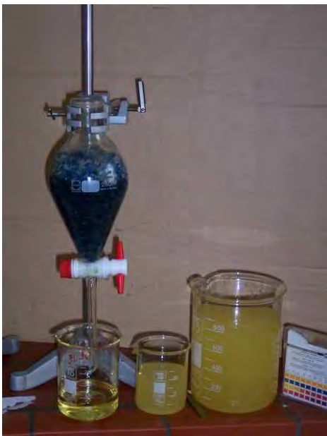
Slika 21: Čiščenje biodizla s silikagelom
