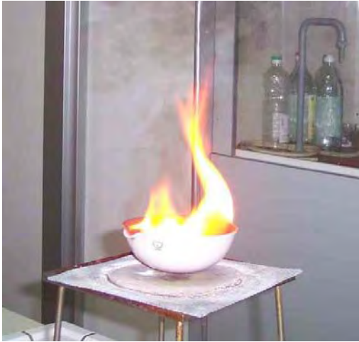
Slika 17: Barva plamena dizelskega goriva
