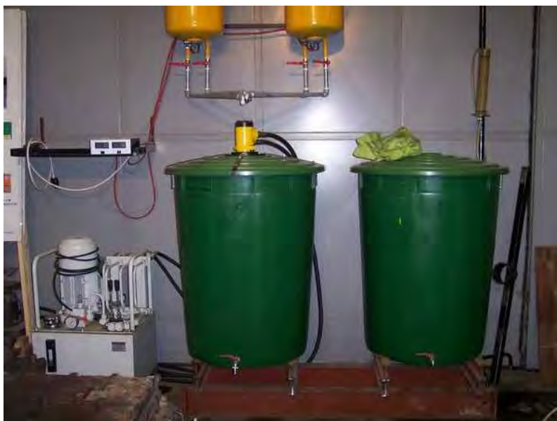
Slika 4: Naprava za pridobivanje biodizla na inštitutu
