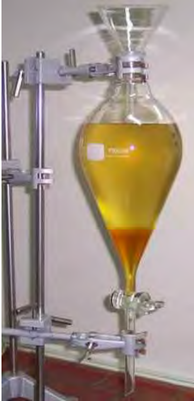
Slika 8: Ločevanje biodizla in glicerola
