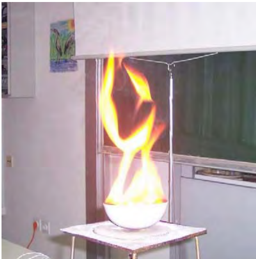
Slika 18: Barva plamena biodizelskega goriva
