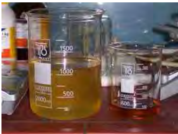
Slika 9: Volumensko razmerje med biodizlom in glicerolom
