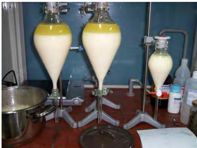
Slika 19: Nastanek emulzije pri čiščenju biodizla
