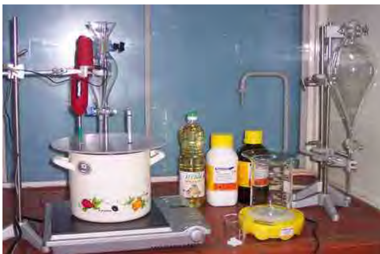
Slika 5: Naprava za pridobivanje biodizla
