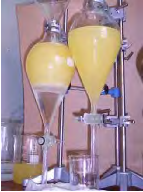
Slika 20: Čiščenje v liju ločniku
