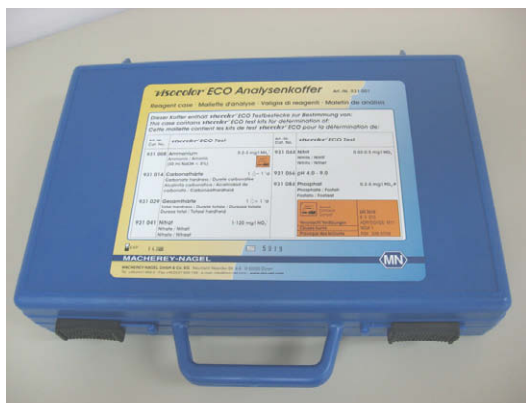
Slika 2: Krovček za analizo vode- zaprt
