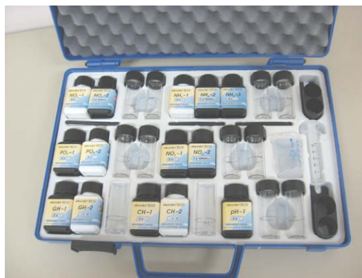
Slika 3: Krovček za analizo vode- odprt
