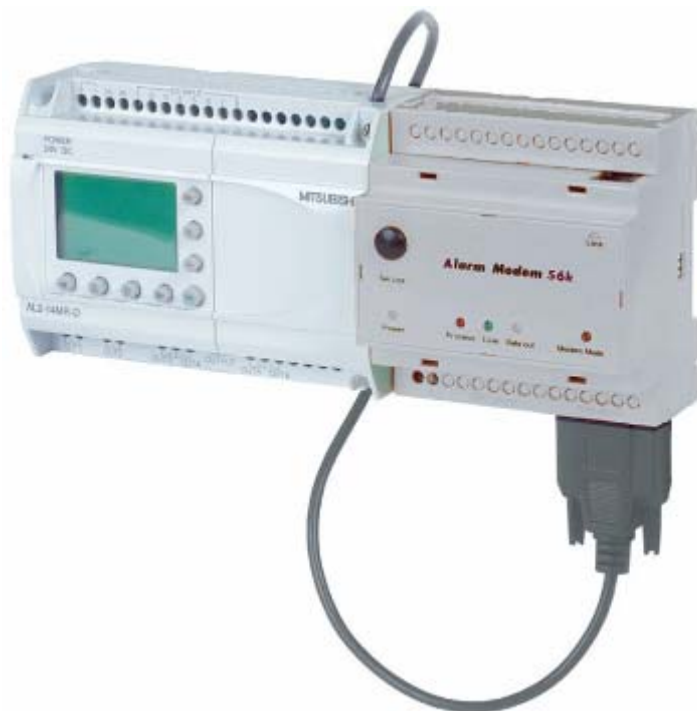
Slika 8: Krmilnik ALPHA XL z nadgradnjo
