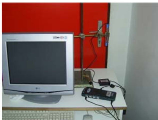
Slika št. 8: Celoten merilni sistem (od leve proti desni): računalniški sistem za obdelavo podatkov, vmesnik in za njim elektroda za merjenje intenzitete, ki jo potopimo v raztopino.
