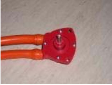
Slika 10: Črpalka za mešanje vode v sekundarnem delu
