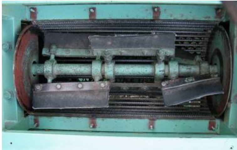
Slika 3: Statični boben s pogonsko gredjo, na kateri so gumijaste lopatice
