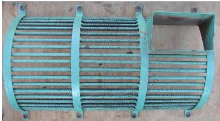
Slika 4: Zgornji del bobna z odprtino za vnos lešnikov
