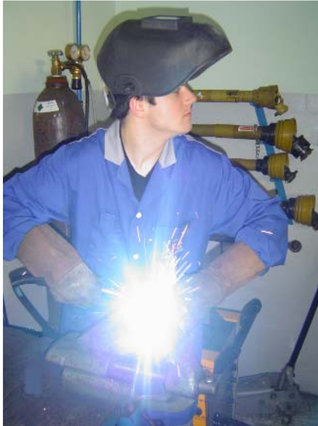
Slika 9: Varjenje ohišja reduktorja
