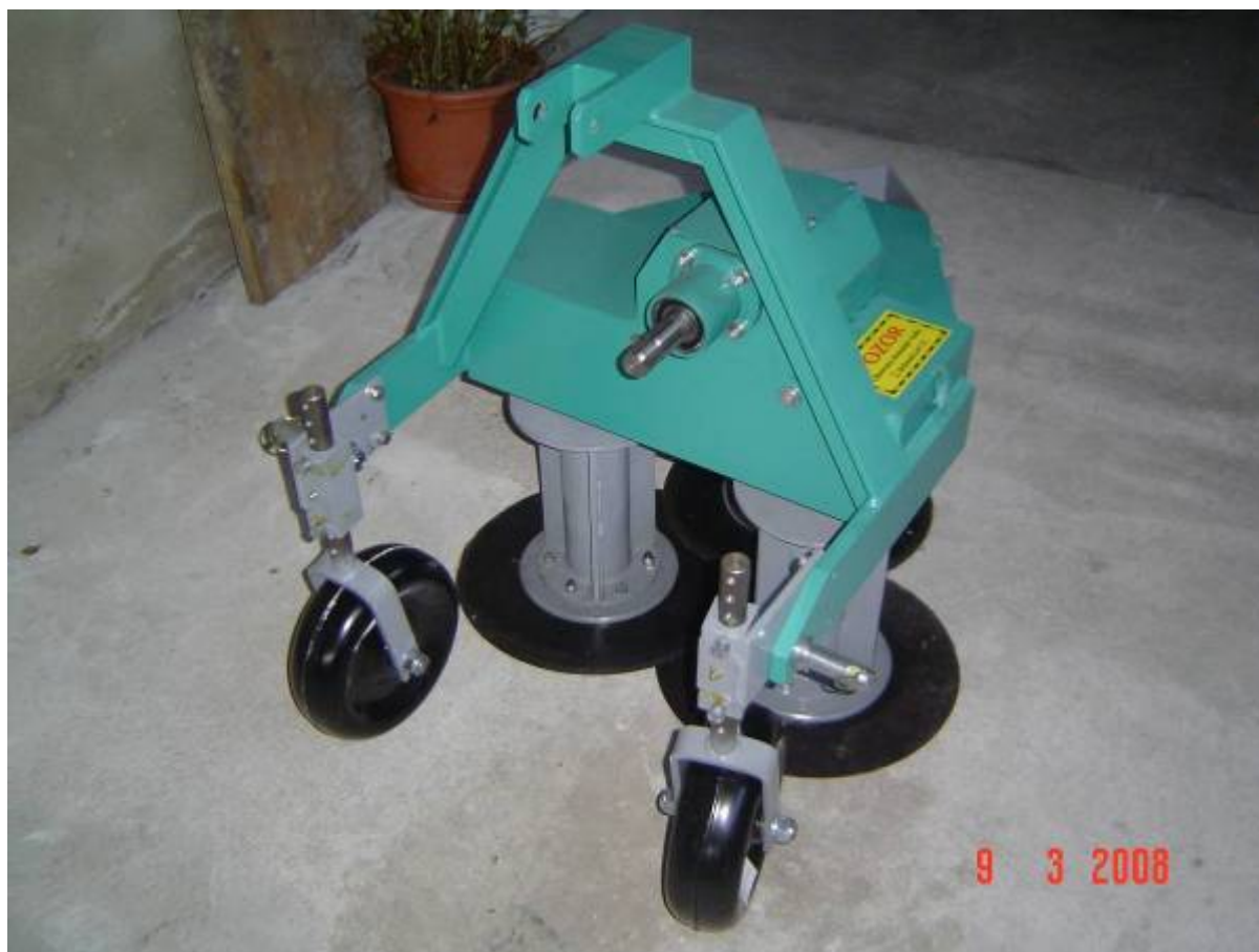
Slika 1: Rezalnik za odrezavanje hmeljskih poganjkov s kardanskim pogonom
