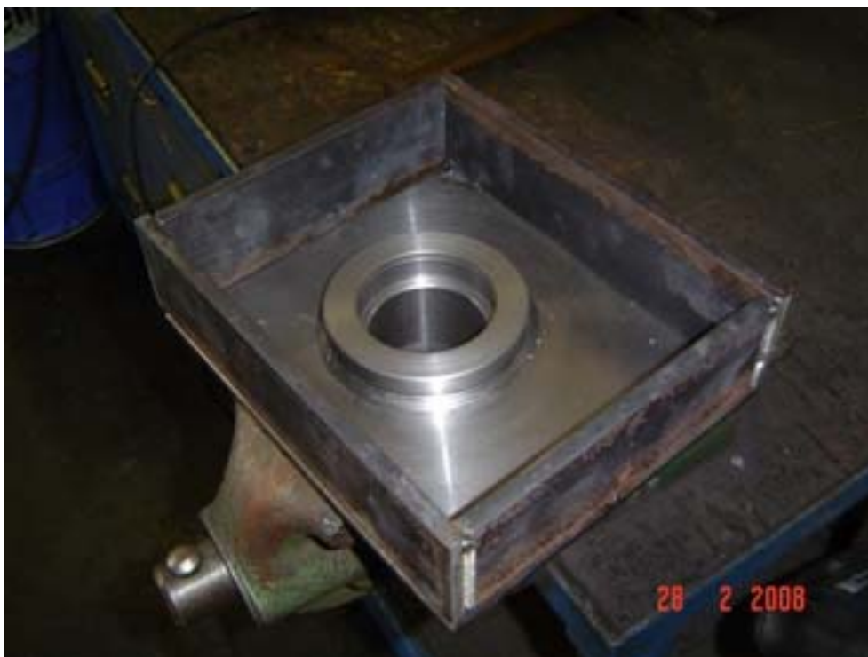
Slika 11: Reduktor med izdelavo
