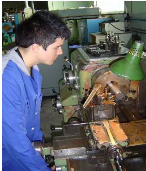
Slika 10: Struženje osi reduktorja
