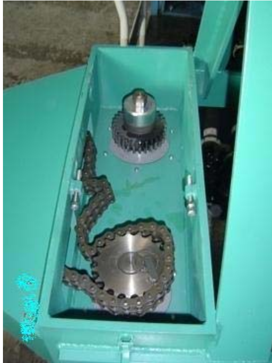
Slika 13: Pozicija reduktorja na rezalniku
