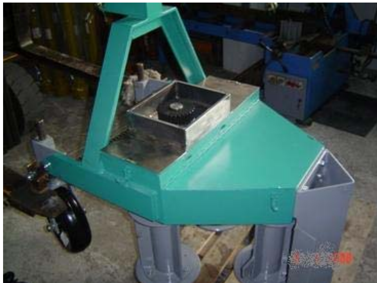
Slika 14: Nameščen reduktor, brez pokrova in hidravličnega motorja
