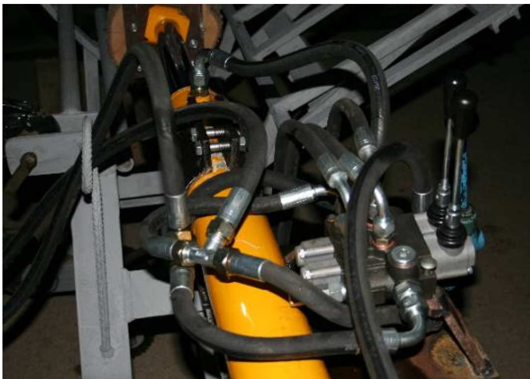
Slika 31: Vse hidravlične komponente nameščene na cepilniku
