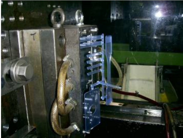
Slika 10: Polovica orodja s končnim izdelkom
