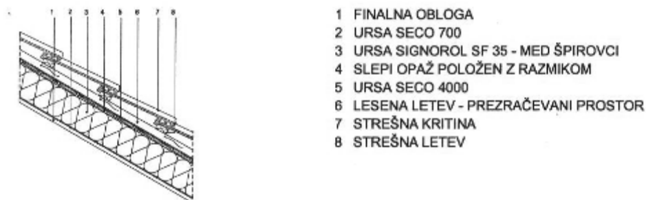
Slika 22: Strešna konstrukcija poševne strehe.
