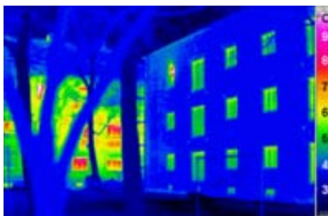
Slika 3: Termografski posnetek pasivne hiše.
