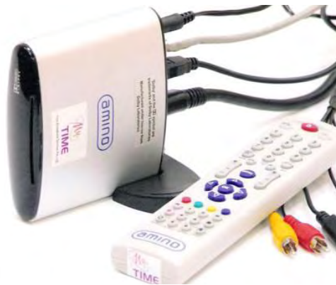
Slika 3: STB sprejemnik, pretvornik IPTV sistema.
