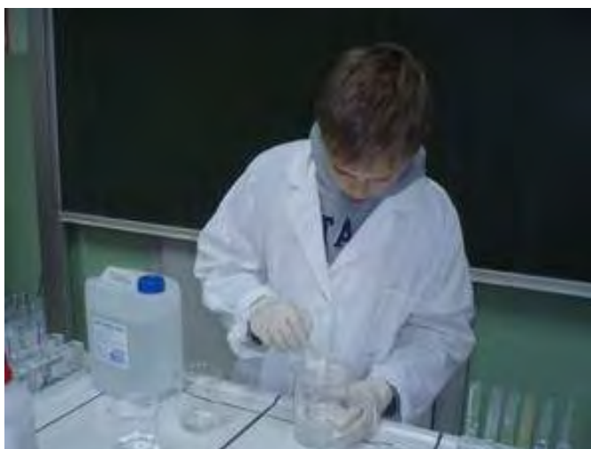
Slika 6: Priprava raztopine vodnega stekla
