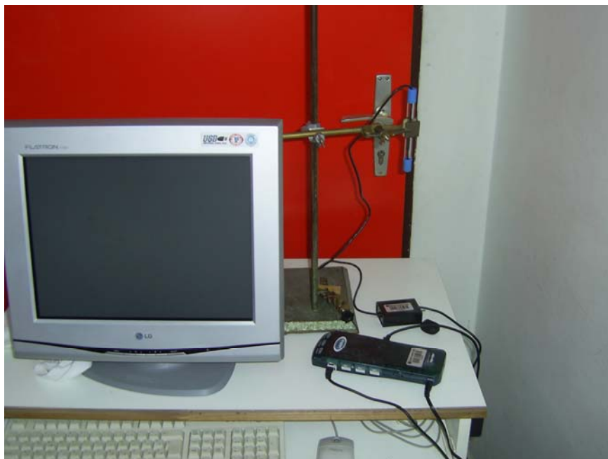
Slika 8: Celoten merilni sistem (od leve proti desni): računalniški sistem za obdelavo podatkov, vmesnik in za njim elektroda za merjenje intenzitete, ki jo potopimo v raztopino.
