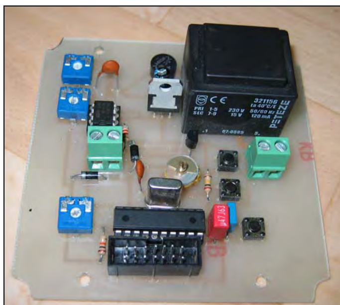
Slika 18: Postavitev elementov na tiskanini
