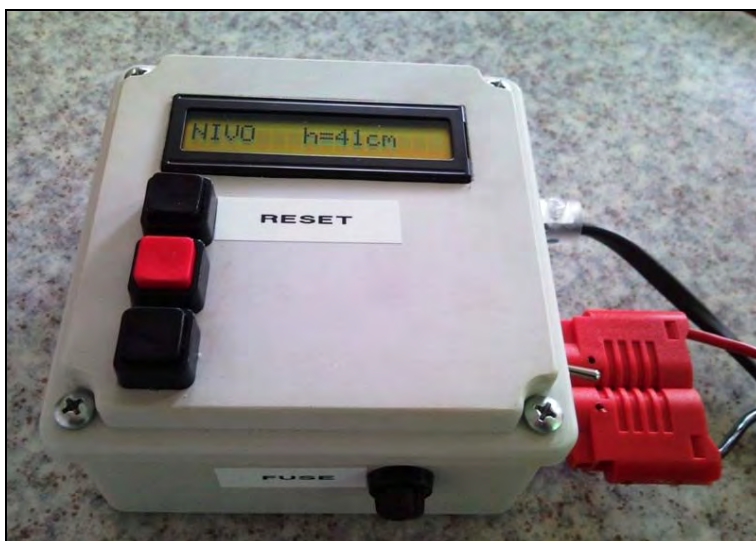
Slika 10: Izhodni prikaz nivoja vode na LCD zaslonu
