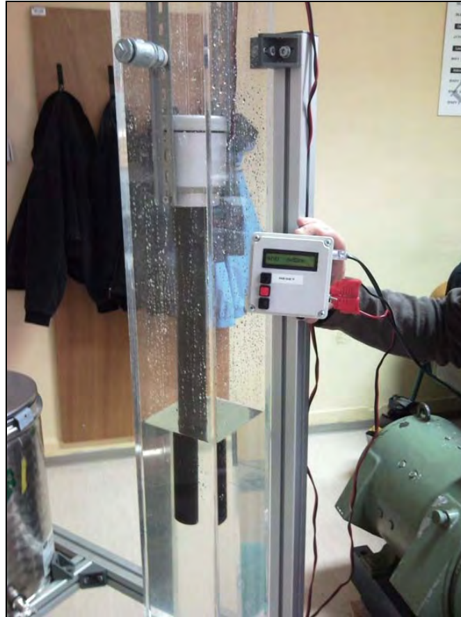
Slika 11: Celotni merilni sistem s sondo in prikazovalnik nivoja vode
