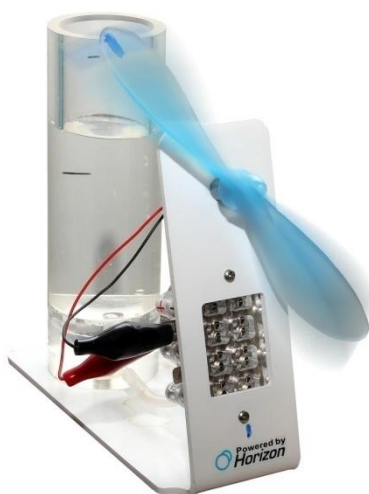
Slika 3: Model gorivne celice z dodatnim elektromotorčkom, ki smo ga uporabljali pri izvedbi poskusov.
