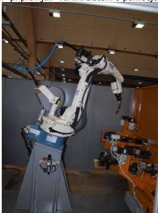
Slika 7: Varjenje s pomočjo robotske roke.
