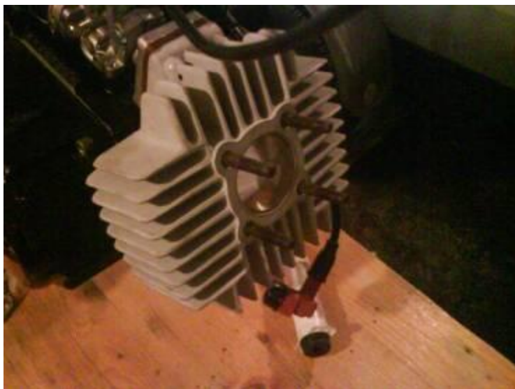
Slika 20: Nameščen je nov bat, uplinjač in del cilindra.
