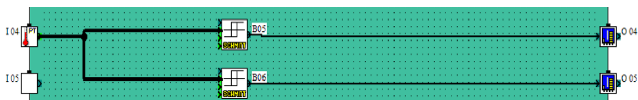
Slika 6: Grafični prikaz programa za regulacijo temperature iz Alpha2
