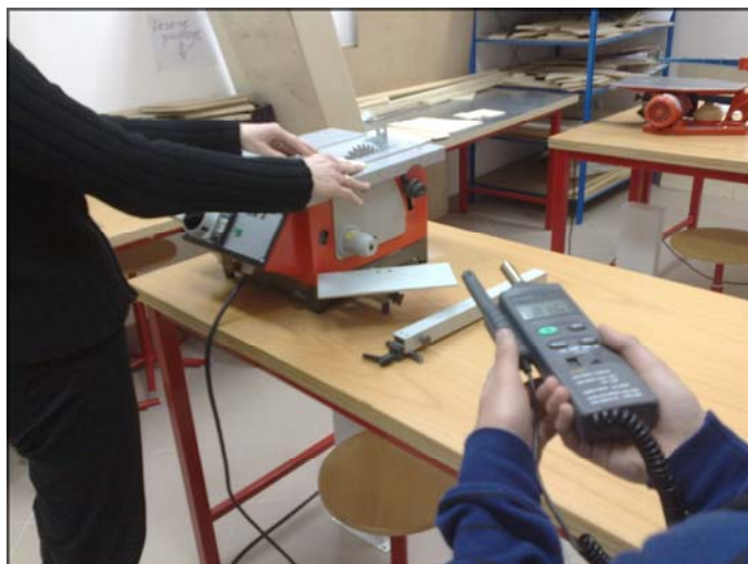
Slika 4: Rezanje lesa s krožno žago
