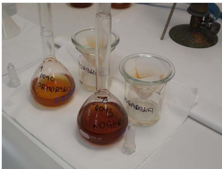
Slika 20: FILTRIRANJE DVEH VZORCEV
