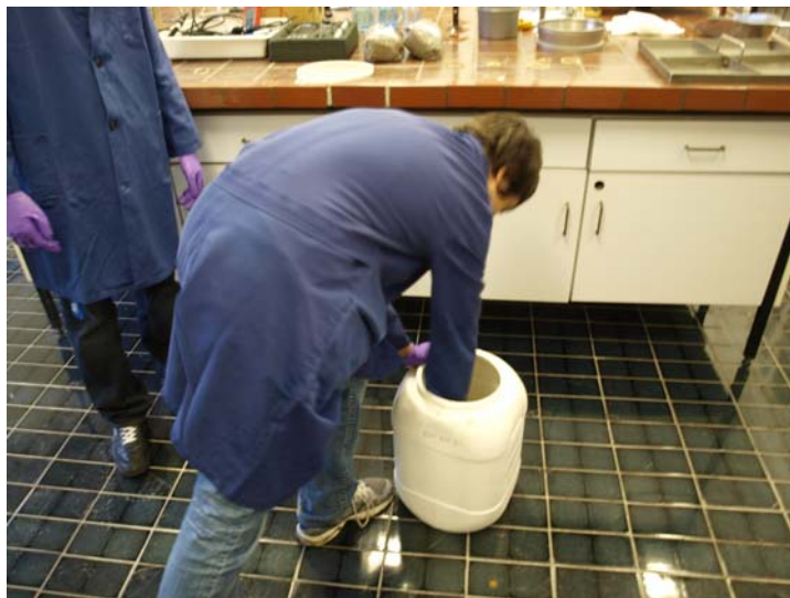
Slika 10: MEŠANJE VZORCEV ZEMLJE V POSODI
