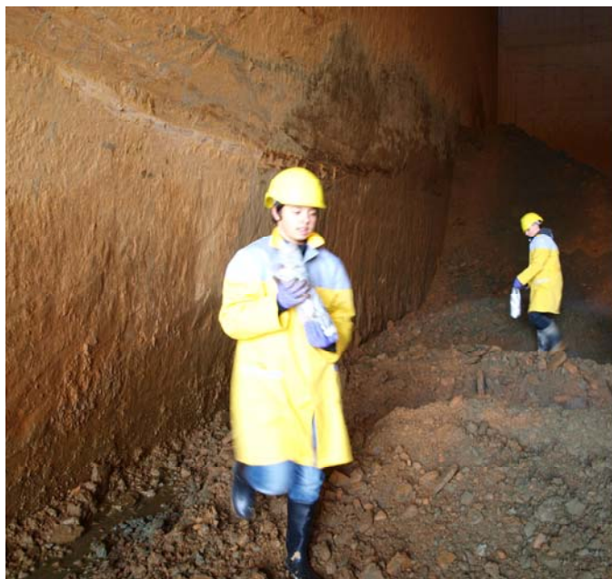
Slika 7: JEMANJE VZORCEV RDEČE SADRE
