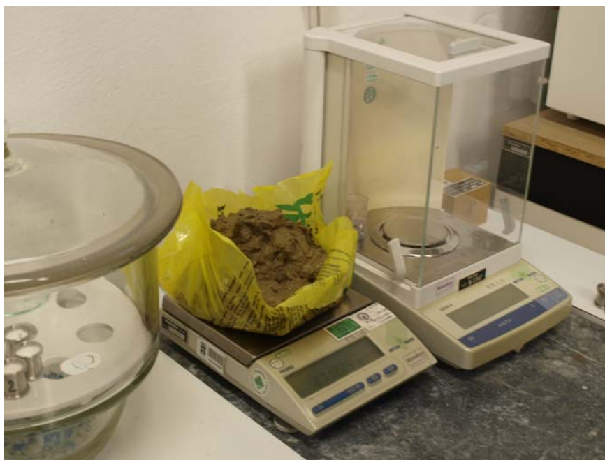
Slika 12: TEHTANJE VZORCA ZEMLJE
