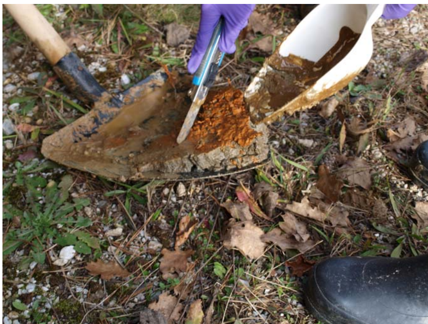
Slika 6: JEMANJE VZORCA ZEMLJE Z OLFA NOŽEM
