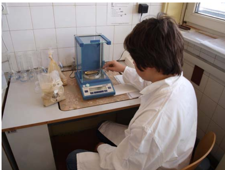
Slika 15: TEHTANJE VZORCA ZEMLJE
