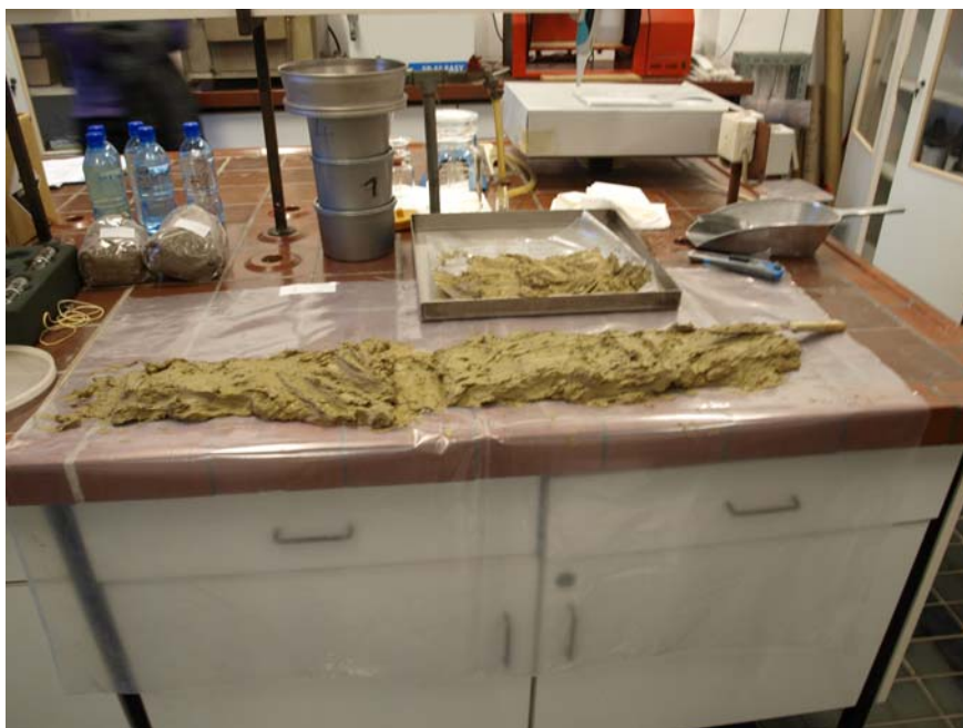
Slika 11: POLOVIČENJE MEŠANEGA VZORCA
