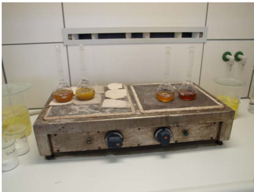
Slika19: SEGREVANJE VZORCEV NA ELEKTRIČNEM GRELNIKU
