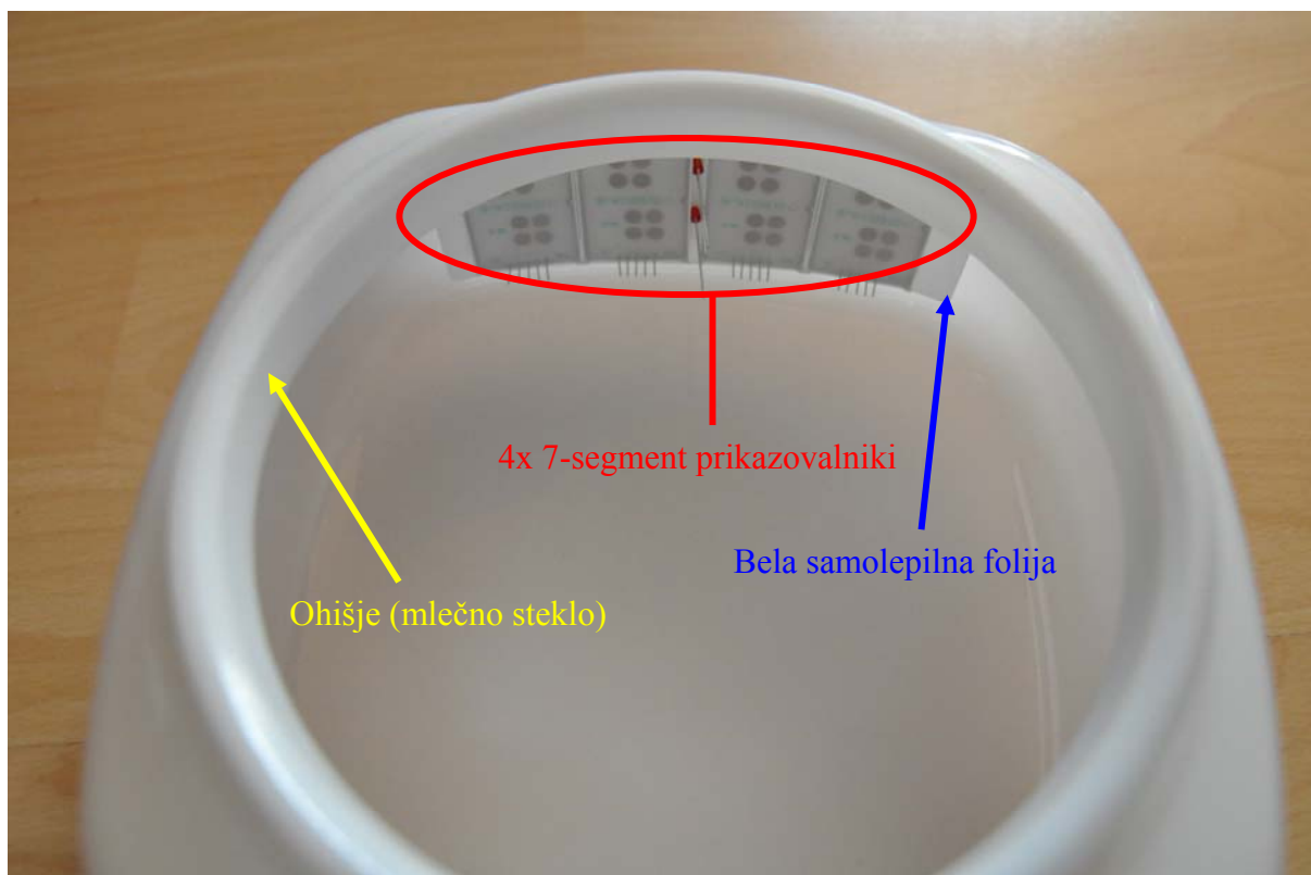
slika 7: Ohišje z vgrajenimi prikazovalniki
