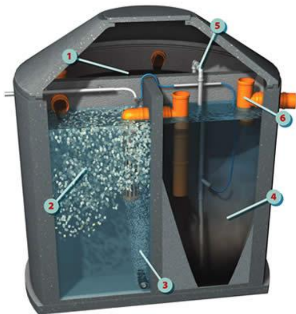
Slika 3: Delovanje male biološke čistilne naprave ( http://montazne-hise-on.net/hisne-cistilne-naprave.html )
