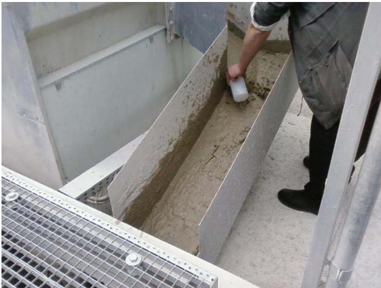
fotografija 2: Vzorčenje odpadne pralne vode-betonarna CM Celje (foto: Lea Vrhovnik, Marja Golež)
