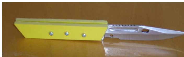
Slika 8: Izgled ročaja noža iz penjenega PVC.
