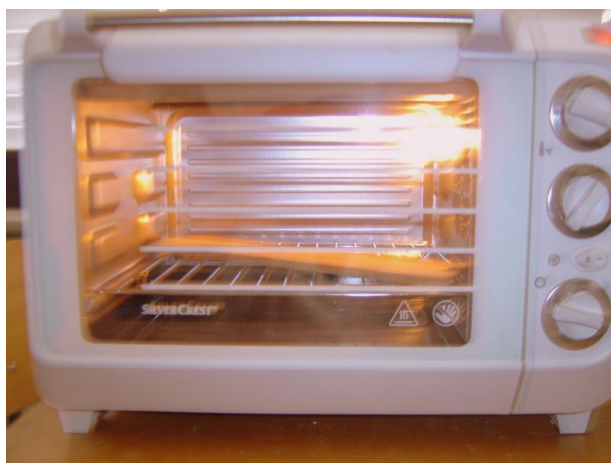
Slika 2: Sušenje lesenih deščic v električni pečici.
