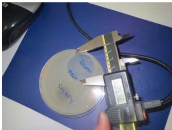
Slika 9: Merjenje velikosti zaviralnega pasu s kljunastim merilom
