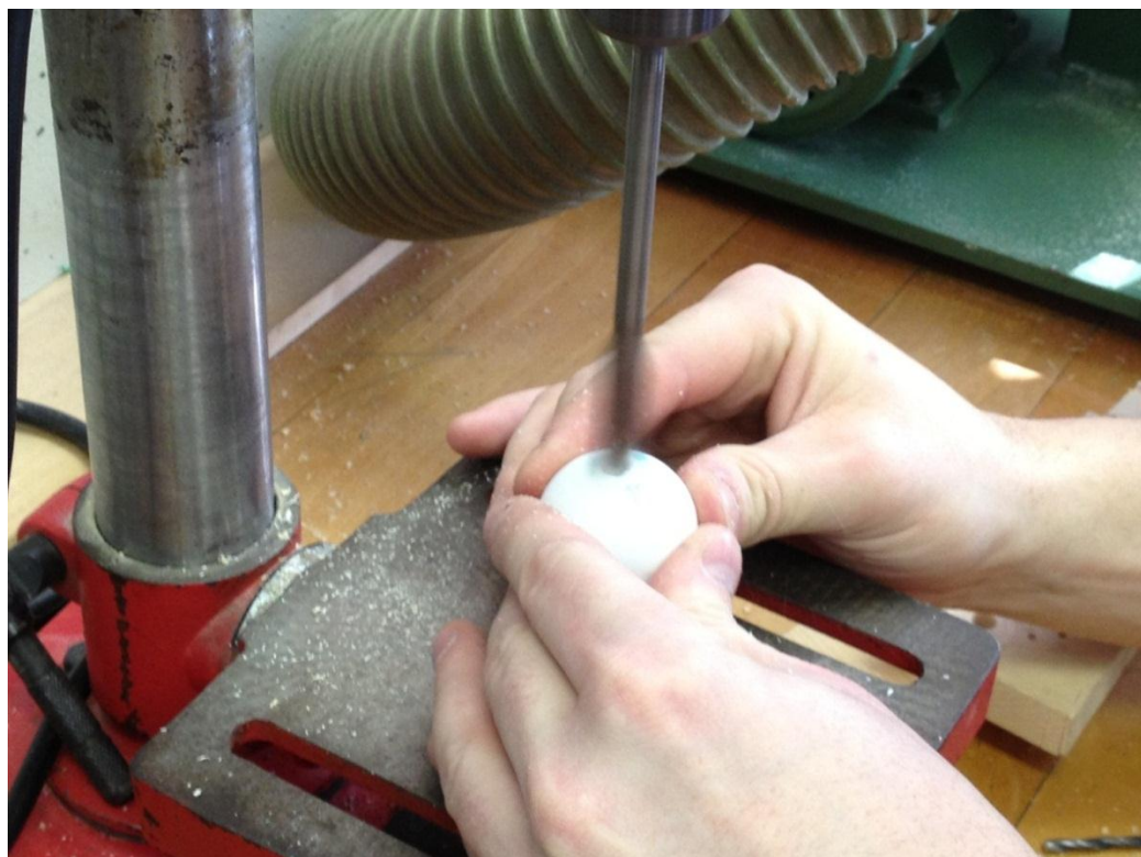
Slika 24: Vrtanje luknje v žogico za namizni tenis
