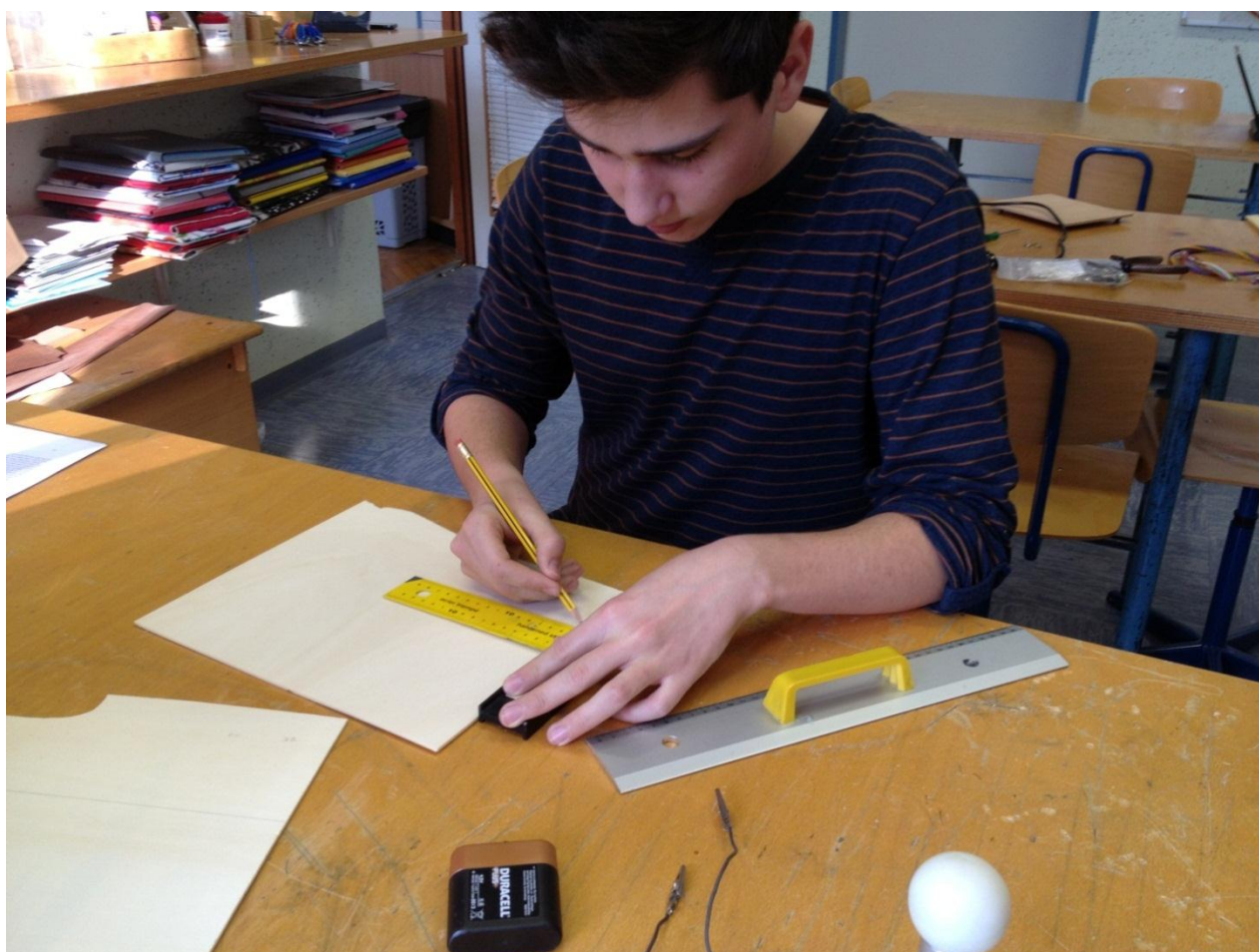
Slika 11: Izdelava lesenega podstavka – zarisovanje dimenzij
