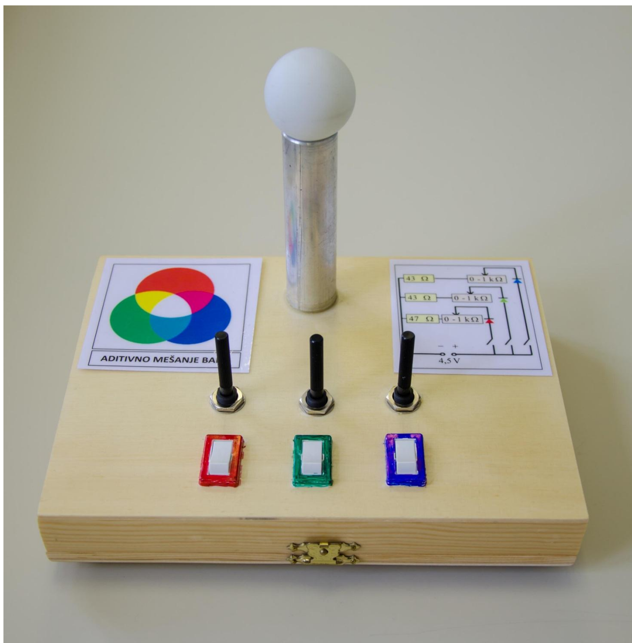
Slika 26: Končni videz fizikalnega učila za prikaz aditivnega mešanja barv
