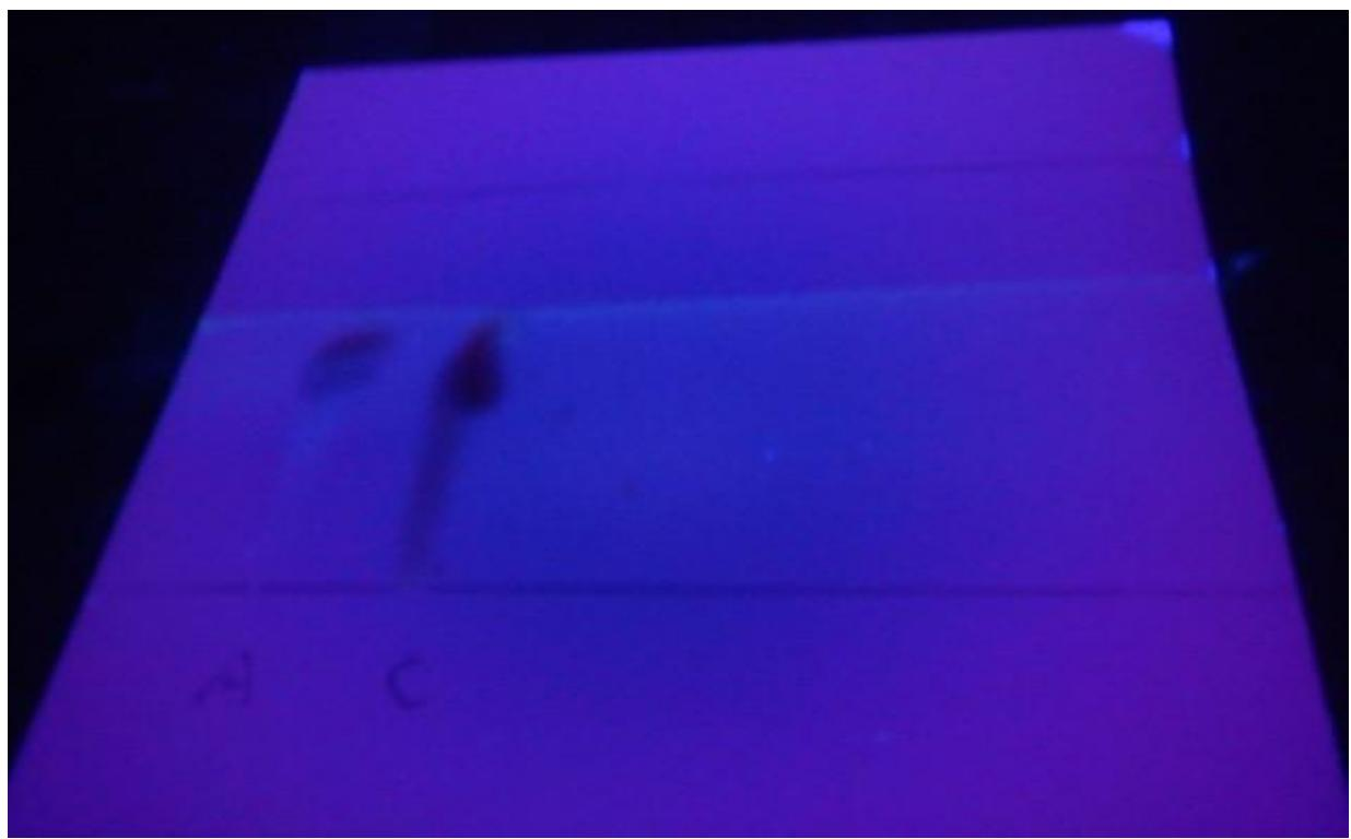
Slika 17: Kromatogram primerjanja čistosti produktov, pridobljenih z etanolom(A) in toluenom(C)
