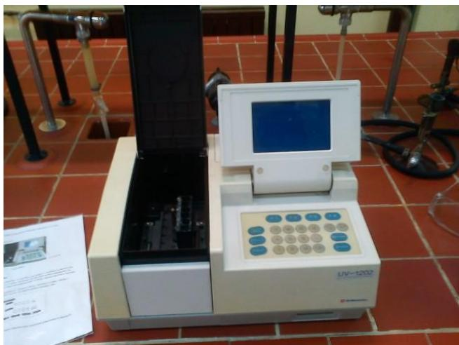
Slika 13: UV-Spektrofotometer.
