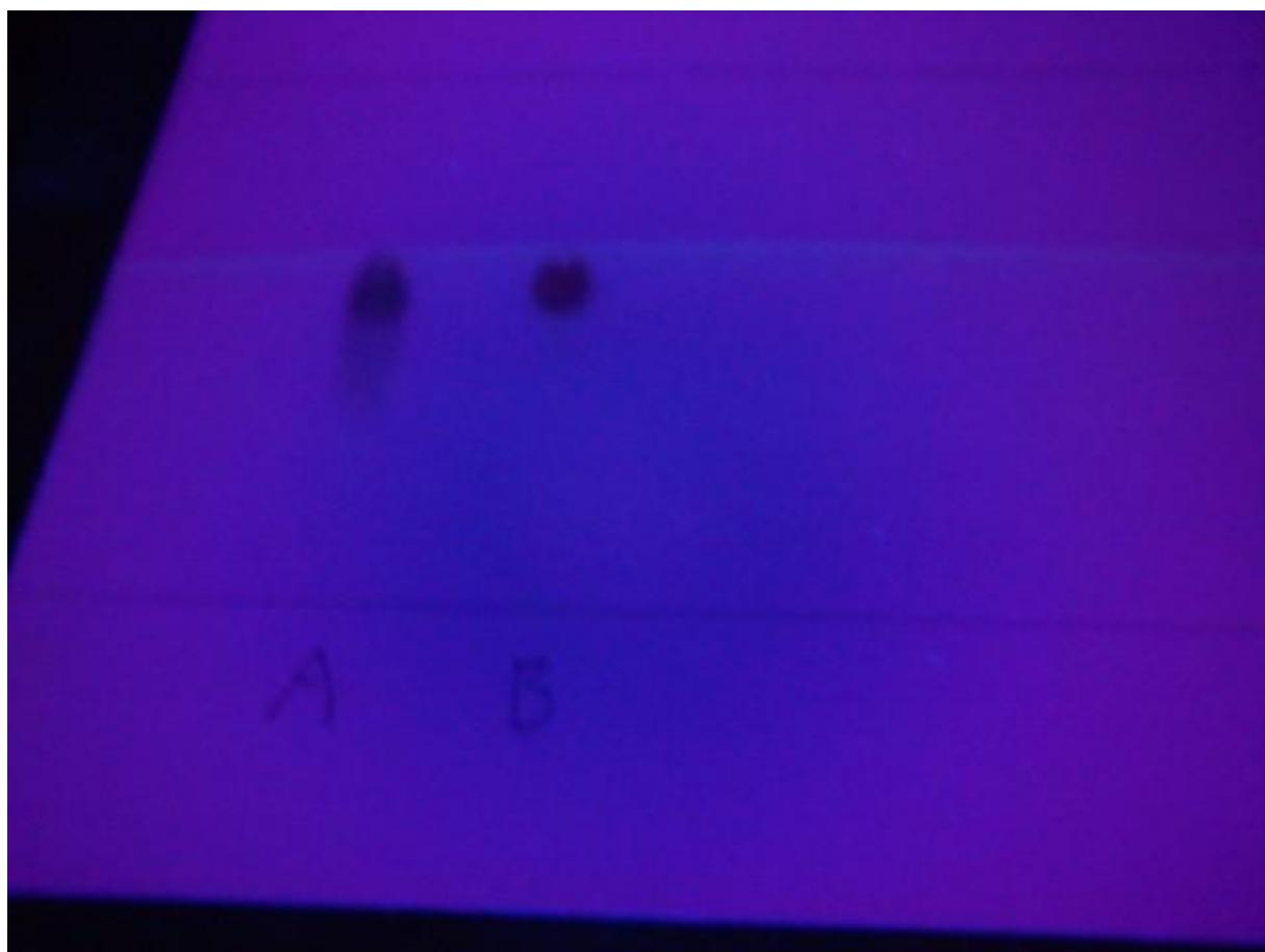
Slika 15: Kromatogram primerjanja čistosti produktov pridobljenih z etanolom(A) in diklorometanom (B)
